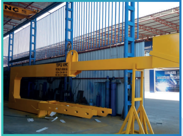
Konteyner İçi Mermer Yükleme Aparatı ( Ayarlı Tip ) / In-Container Marble Loading Apparatus (Adjustable Type)
