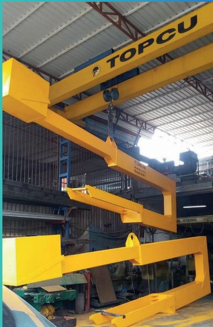
Konteyner İçi Mermer Yükleme Aparatı ( Ayarlı Tip ) / In-Container Marble Loading Apparatus (Adjustable Type)
