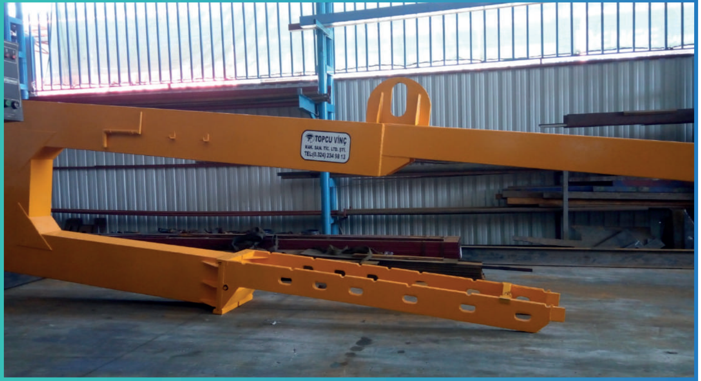
Konteyner İçi Mermer Yükleme Aparatı ( Ayarlı Tip ) / In-Container Marble Loading Apparatus (Adjustable Type)
